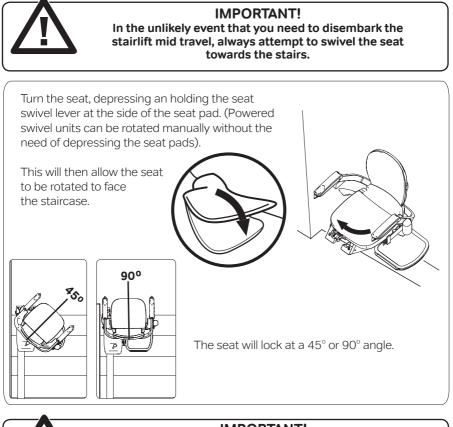
IMPORTANT! MAKE SURE THE SEAT IS LOCKED INTO POSITION BEFORE ATTEMPTING TO DISEMBARK THE STAIRLIFT.
